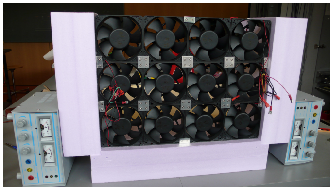
Abbildung 3: Lüftersegment, bereits eingeleimt
