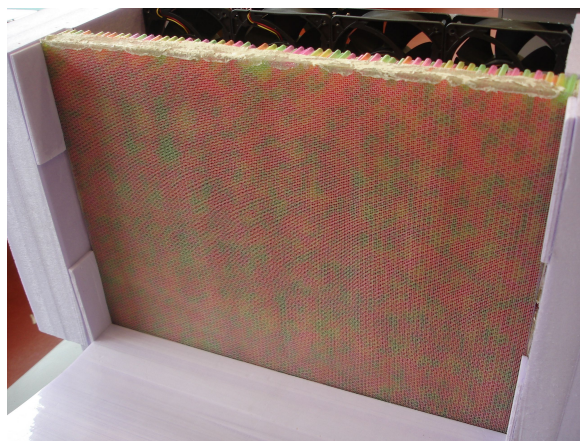
Abbildung 4: Gleichrichter, bereits eingeleimt
